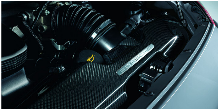
Compartimento motor del 911 Carrera S con la carcasa del filtro de aire de carbono del rectificado de motor
