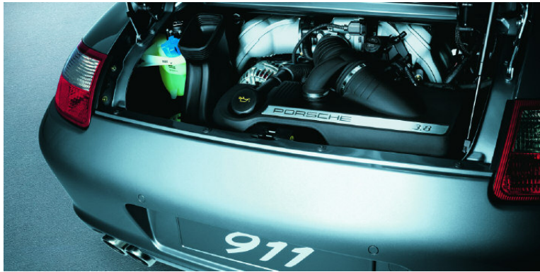
Compartimento motor del 911 Carrera S con el grupo propulsor de serie de 3,8 litros
